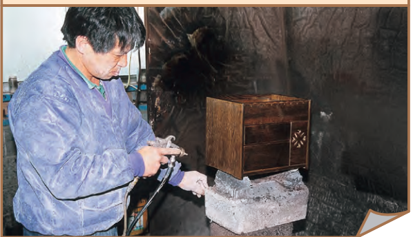
⑦仕上げ塗装(仕上げ用の塗料を吹き付けます。)
