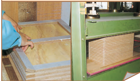
②接着「フラッシュ構造」(部品に接着剤をつけて機械で押さえます。)
