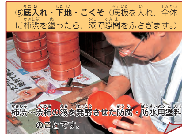
⑤底入れ・下地・こくそ (底板を入れ、全体に柿渋を塗ったら、漆で隙間をふさぎます。)
