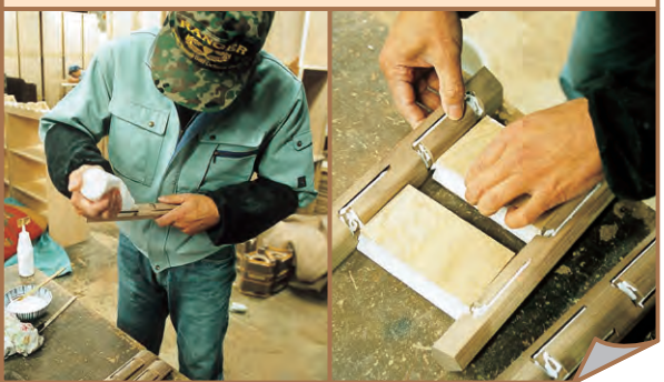
③組み立て・接着(必要な穴や溝などを付けたら、接着剤を塗って組み立てます。)
