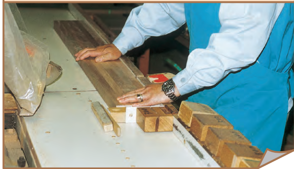
①切り回し(板材や角材を決められた寸法通りに切り、部品をつくります。)
