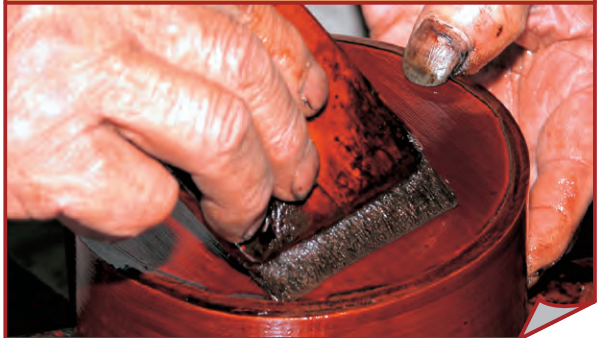
⑧錆研ぎ (乾いた錆漆の表面を紙やすりで磨いて滑らかにします。)
