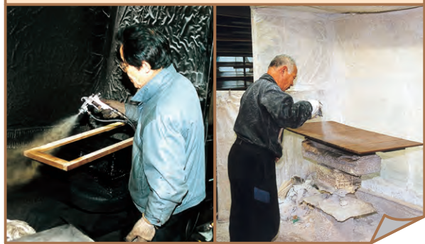
⑤下地塗装(木地に色を塗ったら、次に表面を滑らかにするための塗料を吹き付けます。)
