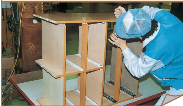
⑥組み立て・まとめ(部品を組み合わせて、扉や金具などを付けます。)
