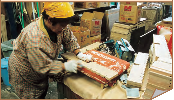
④木地研磨(木地の表面を紙ヤスリで磨いて平にします。)
