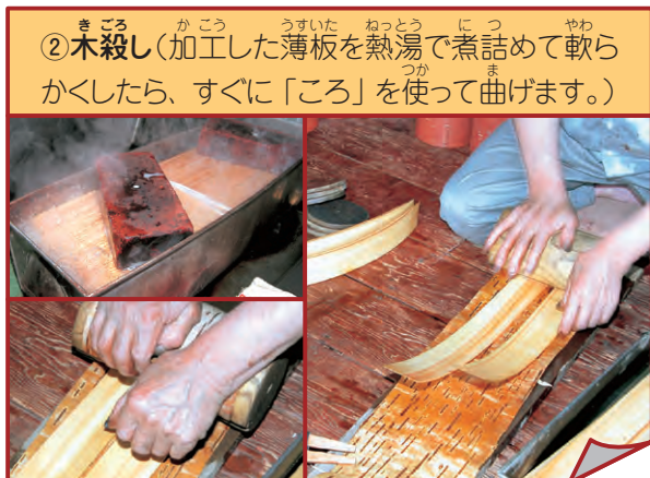
②木殺し (加工した薄板を熱湯で煮詰めて軟らかくしたら、すぐに「ころ」を使って曲げます。)
