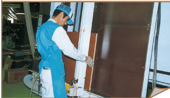
③加工(部品の側面を削って大きさをそろえます。)
