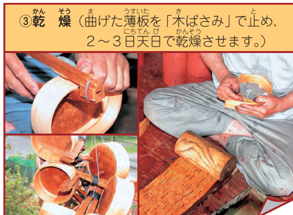
③乾 燥 (曲げた薄板を「木ばさみ」で止め、2~3日天日で乾燥させます。)
