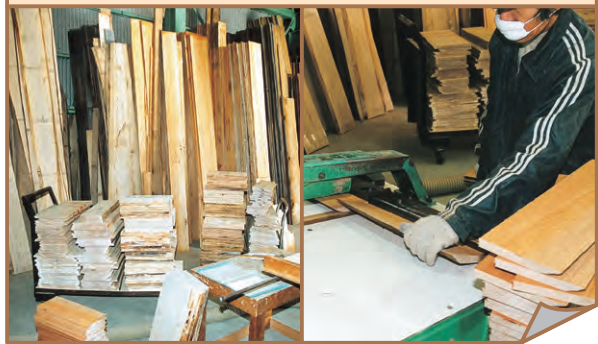
①木取り(十分に乾かした板を必要な長さに切ります。)
