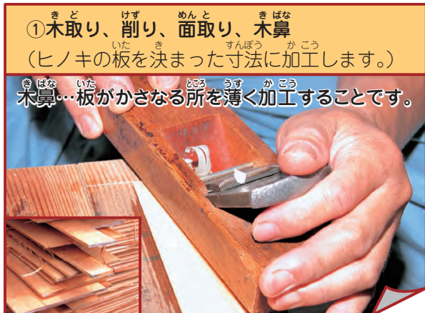
①木取り、削り、面取り、木鼻 (ヒノキの板を決まった寸法に加工します。)
